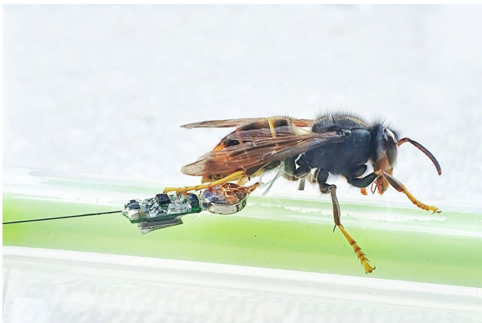
Illustration 6: frelon asiatique (environ 350 mg), avec émetteur PicoPip Ag337 (environ 280 mg) de la société Lotek , fixé au moyen d'un fil autour de la base de l'abdomen (canton de Genève, 2020).
